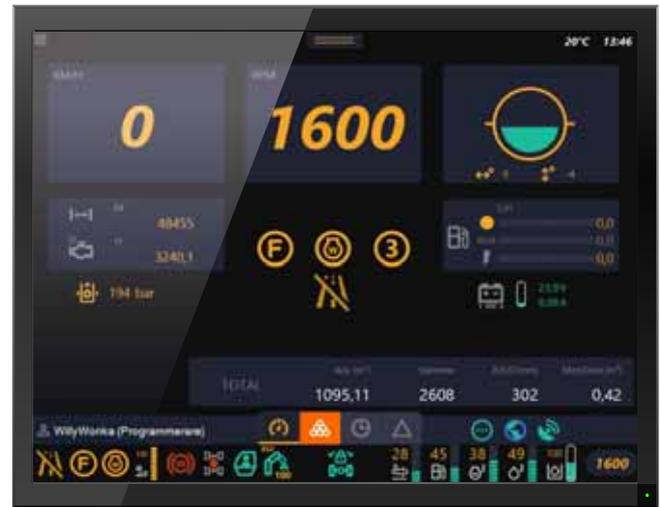
Im MMS-angepassten (Mensch-Maschine-Schnittstelle) Arbeitsmodus zeigen verschiedene Registerkarten die laufende Produktion, die Betriebsinformationen, Maschinenalarme uvm. an. Außerdem überzeugt der moderne Arbeitsmodus mit Farbwahl, Kontrasten sowie Platzierung
