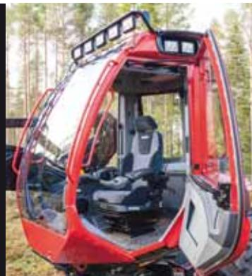
Die neue, größere und geräuschminimierende Fahrerkabine mit vergrößerten Fenstern sorgen für die perfekte Rundumsicht, sowohl nach vorn/unten als auch nach vorn/oben und nach hinten.
