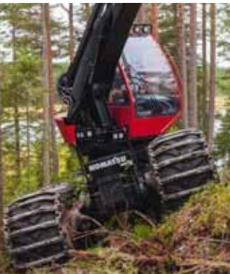
Die Kabinennivellierung sorgt dafür, dass Sie immer ergonomisch sitzen und halbungsbedingten Verspannungen vorbeugen.
