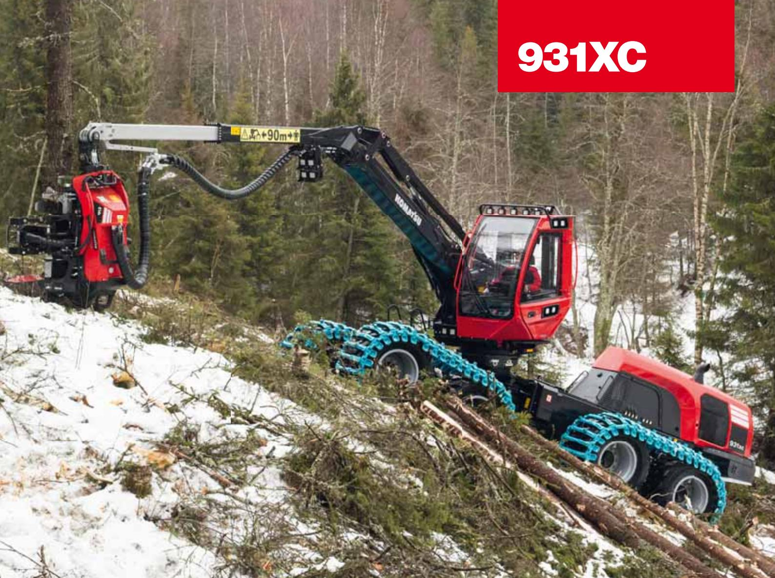
comme le plus efficace. Sur l'abatteuse 931XC, nous avons combiné l'essieu arrière oscillant avec un bogie monté sur un essieu. Résultat : des caractéristiques de conduite uniques qui permettent à la machine de progresser avec une aisance incomparable sur les terrains irréguliers. Une grue à la puissance de rotation élevée et la garde au sol élevée de la machine sont des caractéristiques particulièrement appréciées dans les terrains en pente et difficiles.
