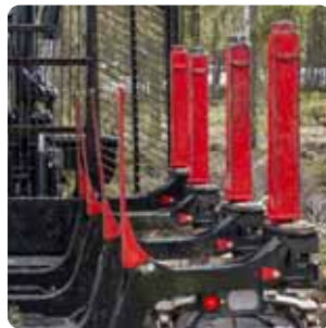
Sortimentsunterteilung mit Trennstützen (Option) Für 835TX mit FlexBunk erhältlich
