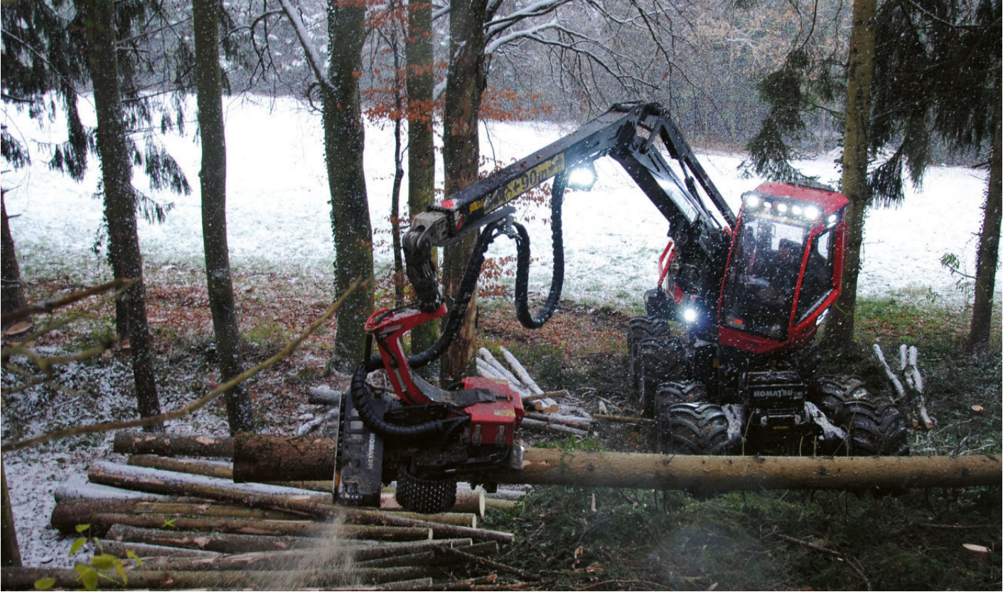
Der 931XC-Harvester bei starkem Schneefall. Die achträdrige Maschine bringt eine Maximalleistung von 190 kW und 200 kN Zugkraft. Das Fahrwerk verfügt über zwei ausbalancierte Zahnradbogig. Der Vollernter ist damit sehr geländegängig und arbeitet bodenschonend. Er ist mit dem neuesten S132-Aggregat bestückt, ausgestattet mit der Sägeeinheit Constant Cut von Komatsu. Das S132 eignet sich vorzüglich für die Holzernte im Laubholz und im Nadelholz.
