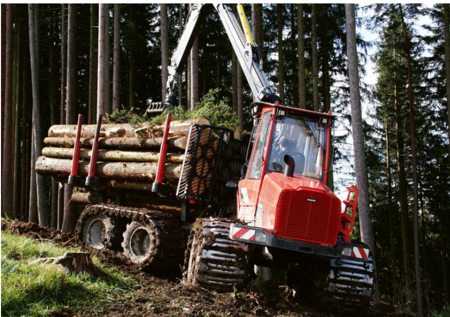
Den Komatsu 845-Forwarder hat das Forstunternehmen Engeli & Marti mit einem breiteren Rungenkorb mit teleskopierbaren Rungen ausstatten lassen. Damit ist die Maschine für die Bringung im steilen Gelände optimiert.
